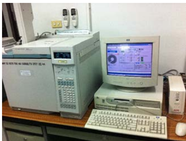
ภาพที่ 3.5 เครื่อง GC/FID รุ่น 6890N
