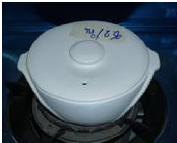
ภาพที่ 4.23 ทดลองเคลือบชิ้นงานตัวอย่าง เผาที่อุณหภูมิ 1250 องศาเซลเซียส
