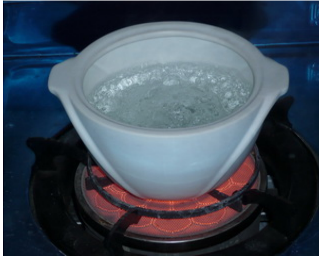
ภาพที่ 4.24 การทดสอบการใช้งานจริงบนเตาแก๊ส
