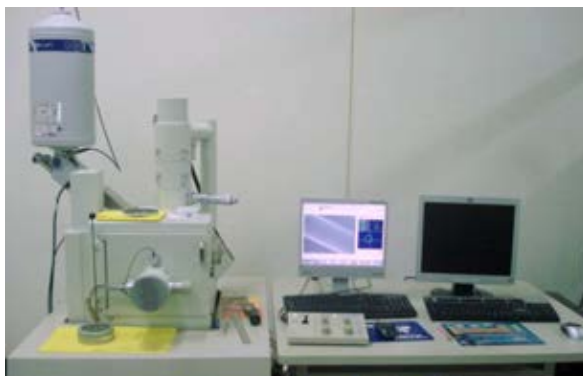
ภาพที่ 3.13 กล้องจุลทรรศน์อิเล็กตรอนแบบส่องกราด (Scanning electron microscope, SEM)
