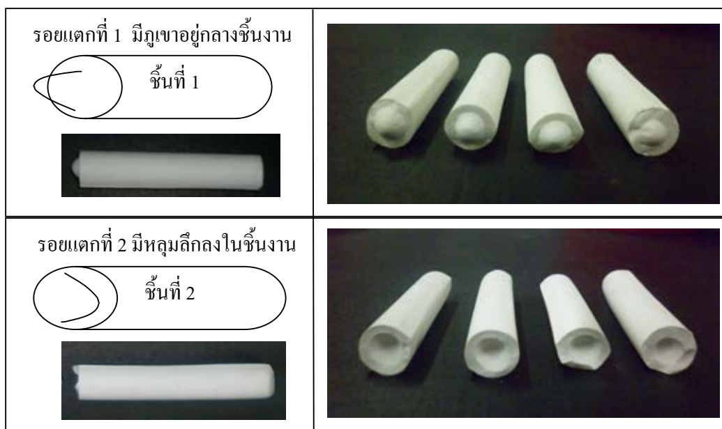
ภาพที่ 4.10 รอยแตกของชิ้นงานหลังเผาในสูตร CS 0
