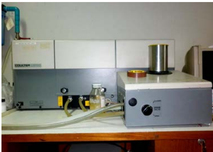
ภาพที่ 3.12 เครื่อง Particle Size Distribution Analyzer PSD
