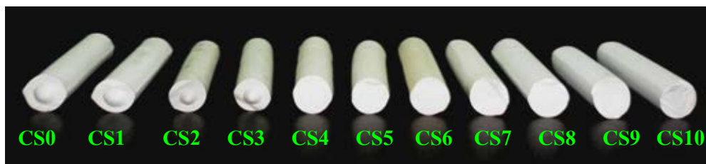
ภาพที่ 4.10 รอยแตกของชิ้นงานหลังเผาในสูตร CS 0
