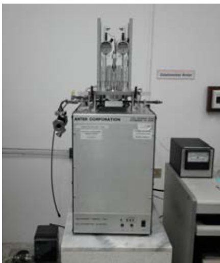
ภาพที่ 3.11 เครื่อง Dilatometer (1161, Anter Unitherm, Italy)
