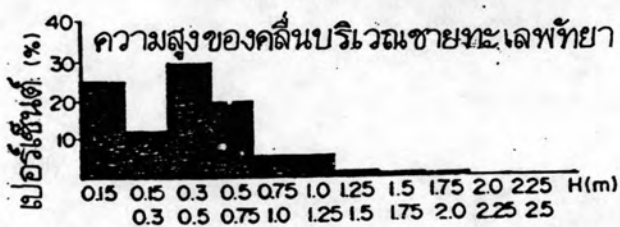
แผนภูมิที่ 3.1 แสดงค่าความสูงและช่วงคลื่นบริเวณชายทะเลพท์ยา
