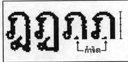
รูปที่ 3.15 แสดงปัญหาที่เกิดจากการตัดแยก และวิธีแก้ไข
