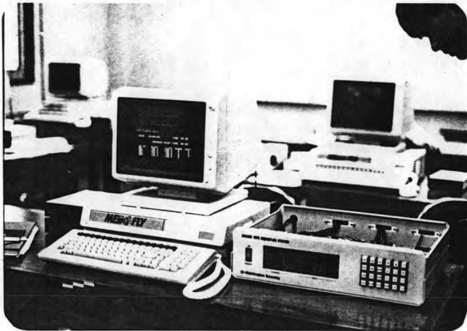
รูปที่ 5.11 แสดงการรับส่งข้อมูลระหว่างเครื่องไมโครคอมพิวเตอร์ กับระบบเก็บข้อมูลแบบอะนาลอก
