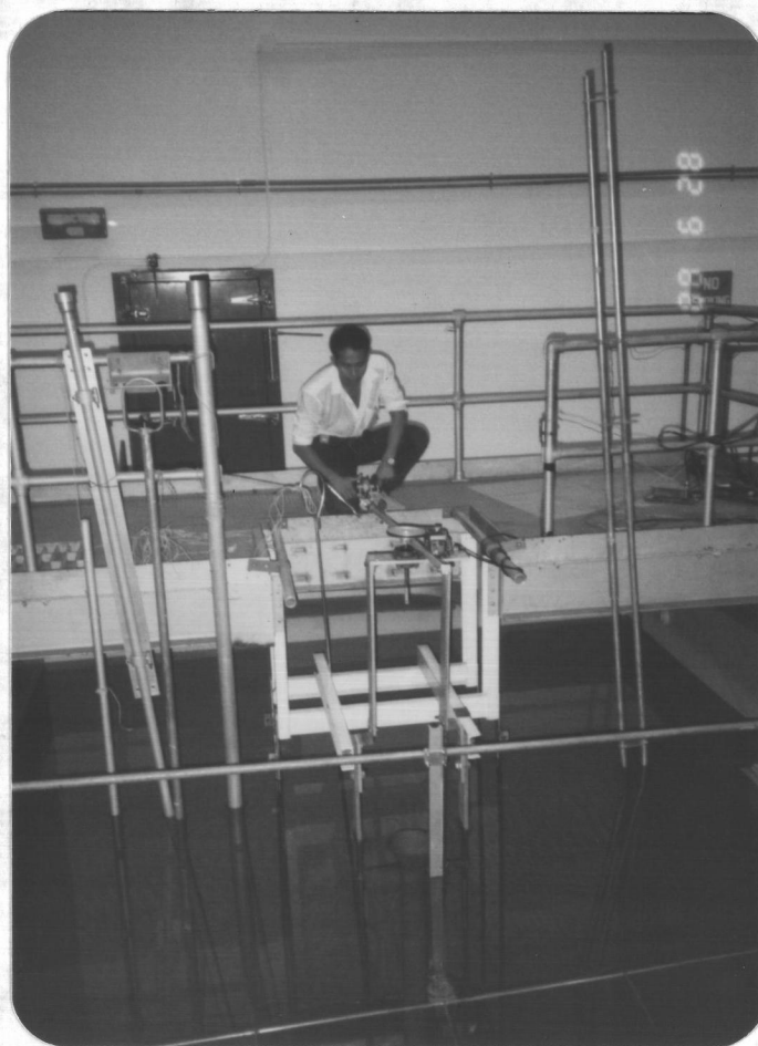
รูปที่ 5.1.3 การติดตั้งหัววัด เข้ากับอุปกรณ์กลสำหรับช่วยวัดอุณหภูมิ
