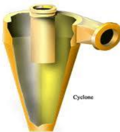
รูปที่ 3.8 ตัวอย่างอุปกรณ์ดักจับฝุ่นแบบไซโคลน (Cyclone)
