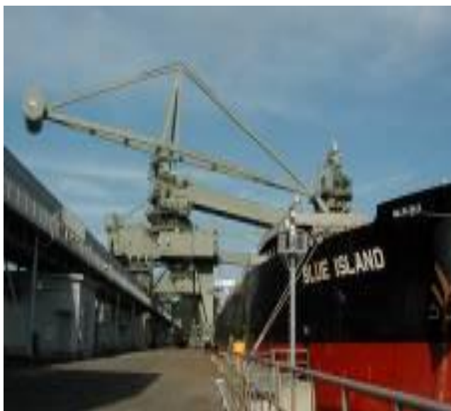
รูปที่ 3.3 การขนถ่ายถ่านหินขึ้นจากเรือด้วยระบบปิด Screw Pipe Unloading
