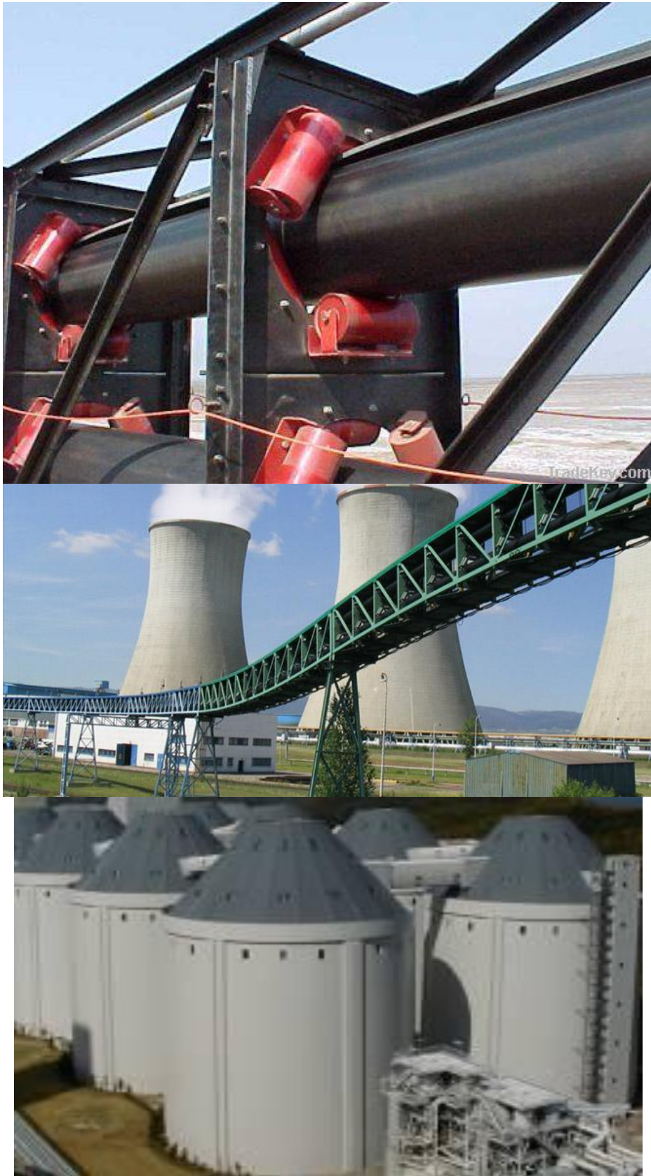
รูปที่ 3.4 การลำเลียงถ่านหิน และการจัดเก็บถ่านหิน ด้วยระบบปิด (Closed System)
