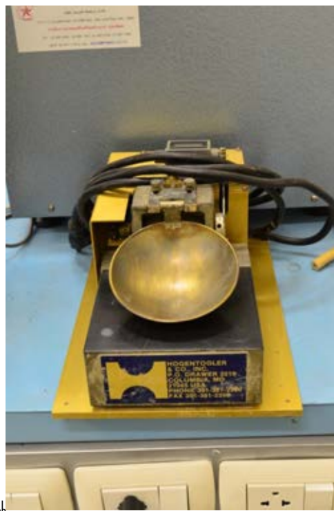
รูปที่ 3-6 เครื่องมือที่ใช้ในการหาค่า Atterberg Limits
