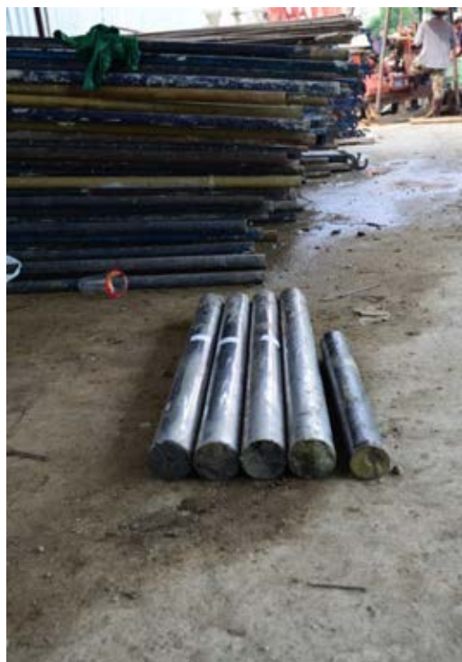
รูปที่ 3-4 กระบอกบางที่ใช้ในการเก็บตัวอย่างดิน
