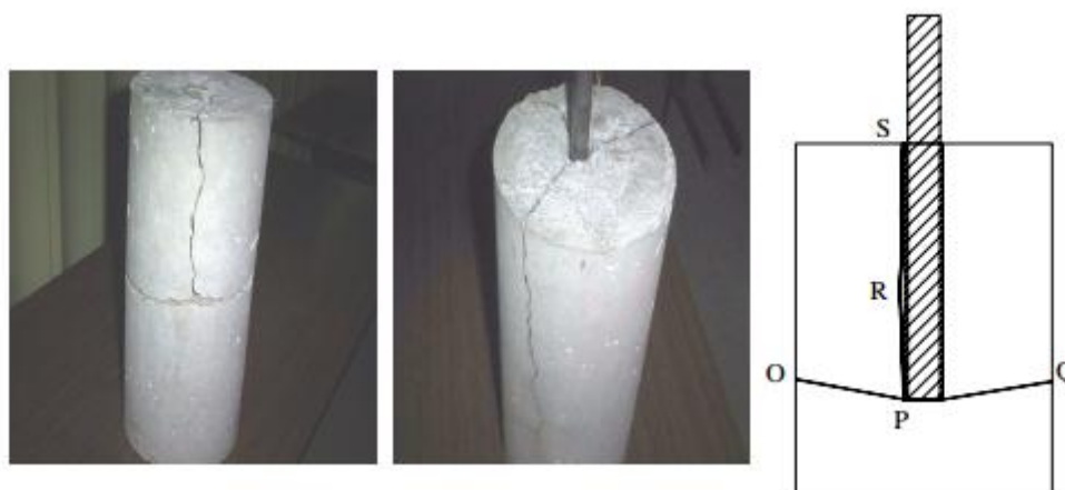
รูปที่ 2.2 ตัวอย่างการวิบัติจากการแตกร้าวของคอนกรีตในการทดสอบการดึงออก ที่อุณหภูมิปกติ [3]
