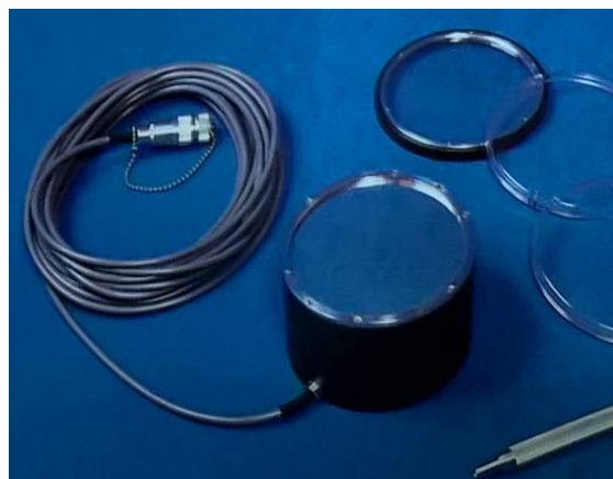
ภาพที่ 18 ไอออนไนซ์เซชันแชมเบอร์ Saint-Gobain Crystals & Detectors UK Ltd รุ่น 2575 600cc thin window ionization chamber
