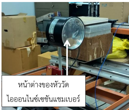
ภาพที่ 18 ไอออนไนซ์เซชันแชมเบอร์ Saint-Gobain Crystals & Detectors UK Ltd รุ่น 2575 600cc thin window ionization chamber
