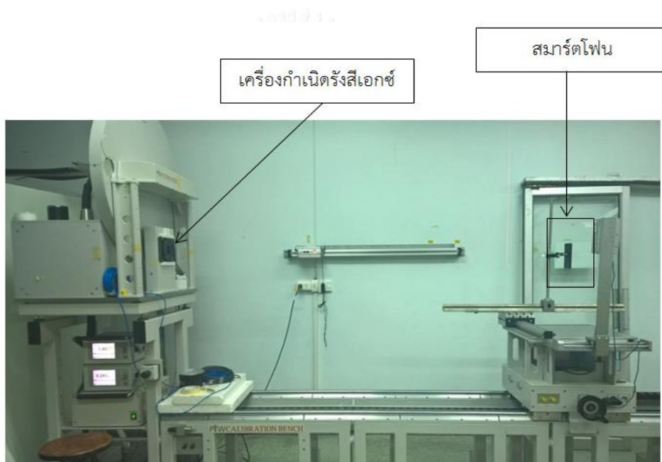
ภาพที่ 22 การจัดวางเพื่อทำการทดลองการเปรียบเทียบรังสีเอกซ์ค่าความต่างศักย์ที่ 100 และ 150 kVp ณ ห้องปฏิบัติการสอบเทียบเครื่องวัดรังสีมาตรฐานทุติยภูมิ (SSDL) กรมวิทยาศาสตร์การแพทย์
