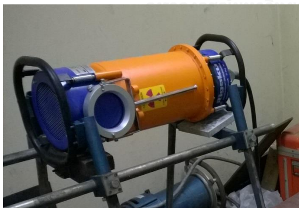
ภาพที่ 11 เครื่องกำเนิดรังสีเอกซ์ Rigaku Radioflex รุ่น Radioflex-200EGM2 (ซ้าย) แผงควบคุม (microcomputerized controller) (ขวา)
