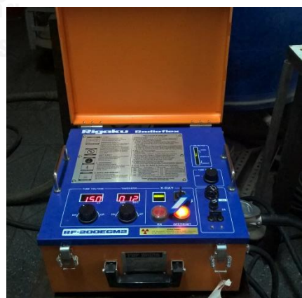
ภาพที่ 11 เครื่องกำเนิดรังสีเอกซ์ Rigaku Radioflex รุ่น Radioflex-200EGM2 (ซ้าย) แผงควบคุม (microcomputerized controller) (ขวา)
