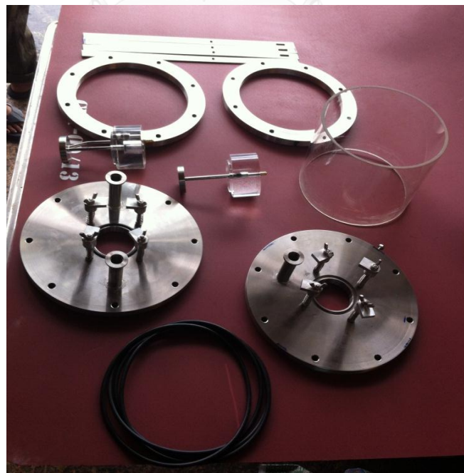
รูปที่ ก.3 ส่วนประกอบของอุปกรณ์เครื่องกำเนิดพลาสมาอย่างง่าย
