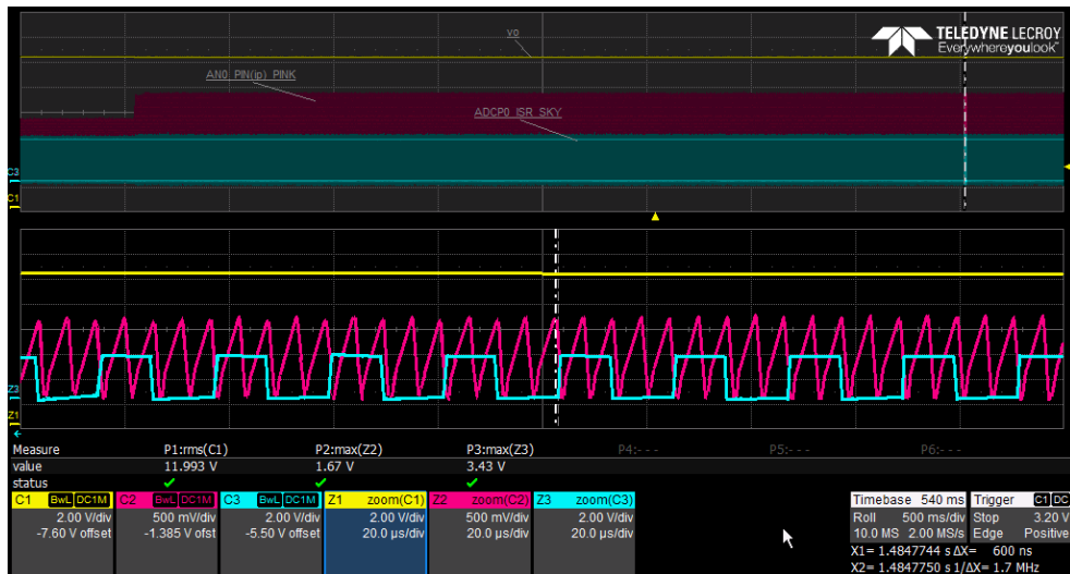
รูปที่ ๓-4 การตรวจสอบการซีกตัวอย่างสัญญาณค่ายอดของกระแสด้านเข้า (20 \mu s/div)
