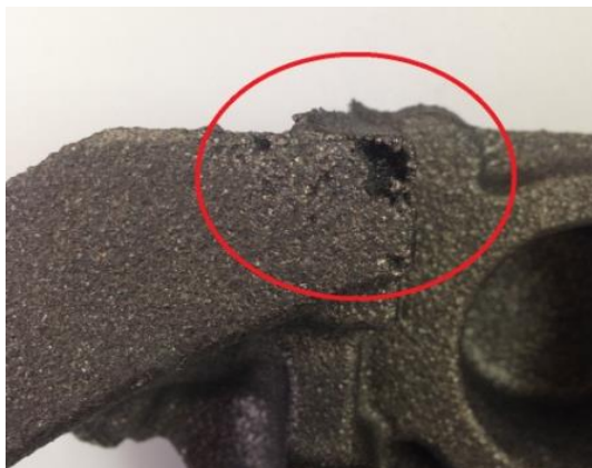
รูปที่ 1.15 ลักษณะของเสียประเภททรายตก
