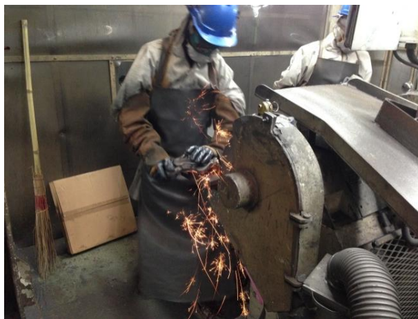
รูปที่ 3.9 การเจียรแต่งชิ้นงาน
