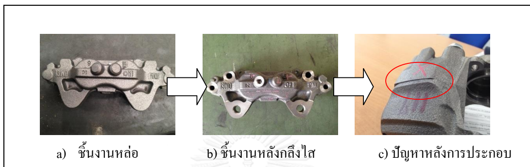
รูปที่ 1.14 ลักษณะของเสียประเภทขนาดผิดรูป
