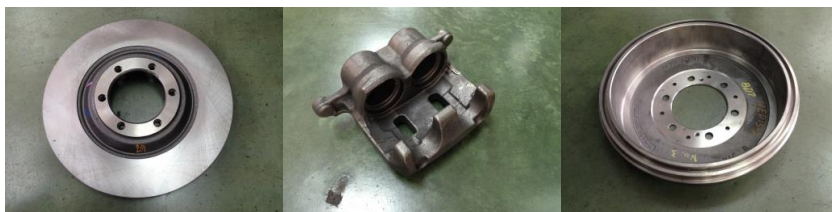
รูปที่ 1.3 ชิ้นงานเหล็กหล่อกลุ่มระบบเบรก
