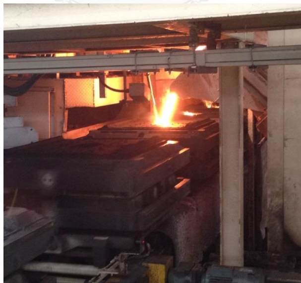
รูปที่ 3.6 การเทน้ำเหล็กลงแบบทราย
