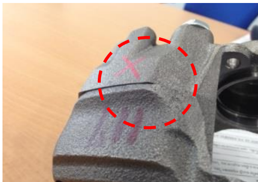
รูปที่ 3.15 ข้อบกพร่องประเภทชิ้นงานผิดรูป
