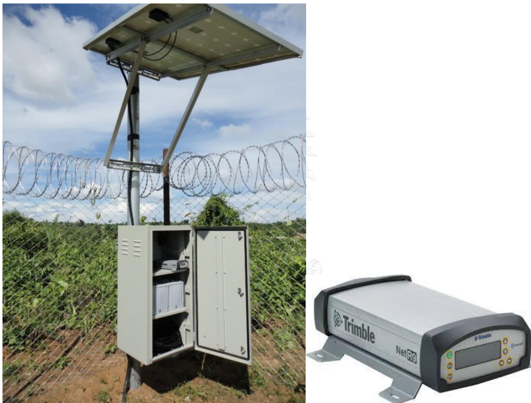
ภาพที่ 3.2 เครื่องรับชนิด Geodatic Trimble Gns NetR8 และ NetR9
