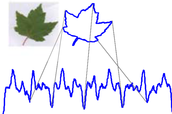
รูปที่ 2.2 การแปลงข้อมูลภาพของใบไม้ เป็นข้อมูลอนุกรมเวลา (ที่มา Ratanamahatana และ Keogh [2])
