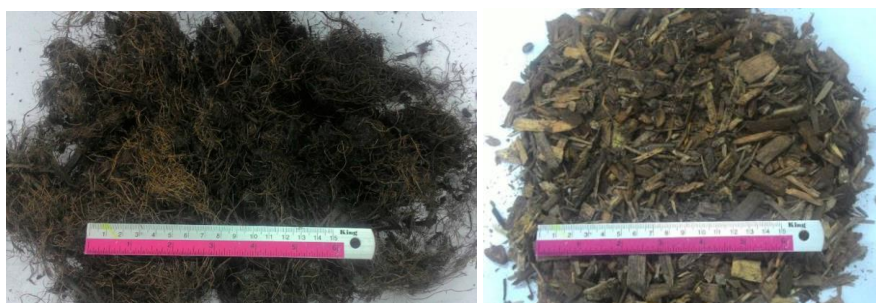
รูปที่ 4.9 ขนาดและลักษณะเชื้อเพลิงที่ใช้ในการอบแห้ง
