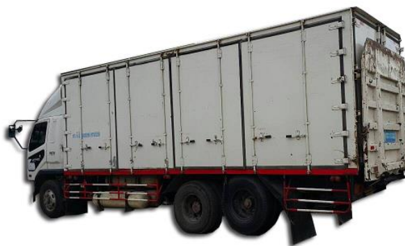
รูปที่ 2.3 แสดงรถสิบล้อแบบมีคังคาและมีลิฟท์ท้าย
