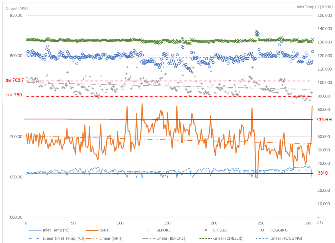
รูปที่ 32 กราฟเปรียบเทียบสภาวะอากาศและกำลังการผลิตของโรงไฟฟ้าก่อนและหลังการติดตั้งเทคโนโลยีการปรับลดอุณหภูมิอากาศ
