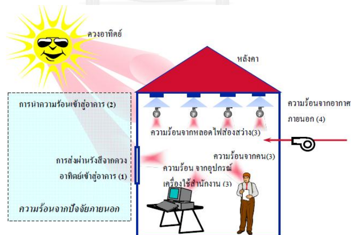
รูปที่ 2.4 แหล่งความร้อนต่างๆ ของภาระการปรับอากาศ
