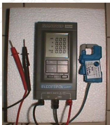
รูปที่ 3.4 เครื่องตรวจวัดกำลังไฟฟ้า (Electrical Power Meter)
