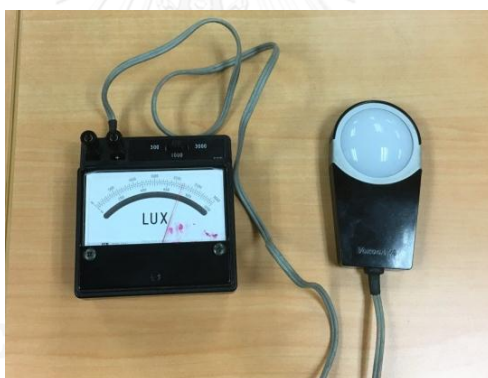
รูปที่ 3.6 เครื่องมือวัดระดับความส่องสว่าง (Lux Meter)
