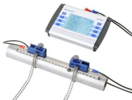
รูปที่ 3.5 เครื่องมือวัดอัตราการไหลของน้ำ (Ultrasonic flow meter)
