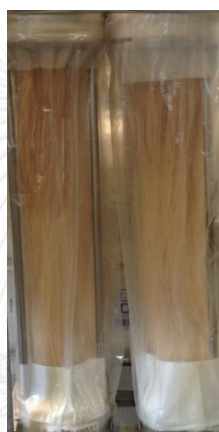
ภาพที่ 3-4 ไมโครฟิลเตรชันชนิดเส้นใยกลวง (Hollow fiber)
