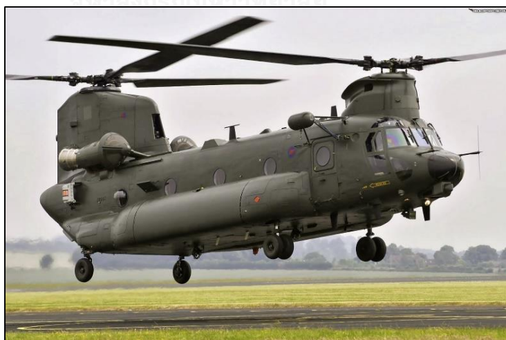
รูปที่ 2.6 เฮลิคอปเตอร์ชนิดแกนหลักสองแกน
