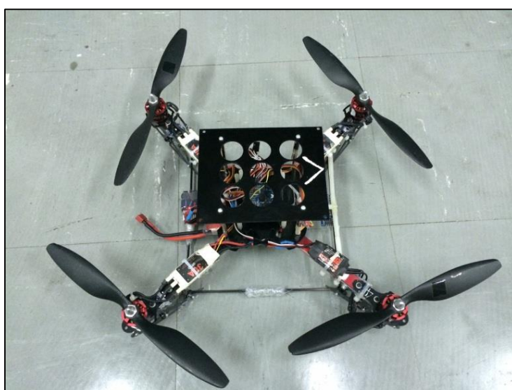
รูปที่ 1.1 อากาศยานสี่ใบพัดที่ใช้ระบบควบคุม Miltiwii v.2
