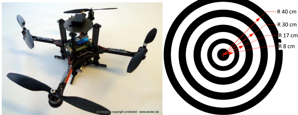
รูปที่ 1.2 อากาศยานสี่ใบพัดรุ่น Pelican และแผ่นเป้าหมาย
