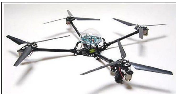
รูปที่ 2.7 เฮลิคอปเตอร์ชนิดใบพัดเดี่ยวหลายแกน
