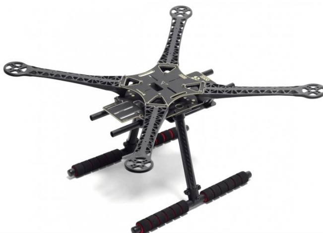
รูปที่ ก.1 แสดงโครงสร้างของอากาศยานสี่ใบพัดที่ใช้ในงานวิจัย
