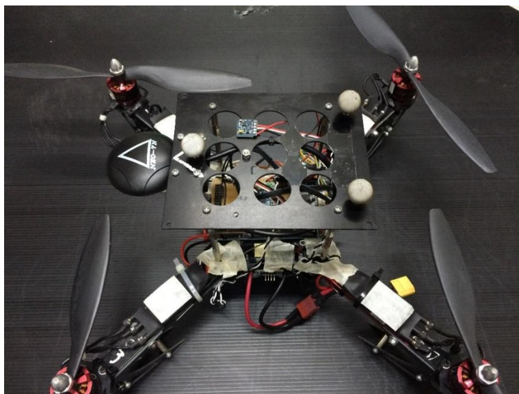
รูปที่ 4.3 แสดงจุดสะท้อนแสงที่ติดตั้งบนอากาศยานสี่ใบพัดที่ใช้ในการทดลอง
