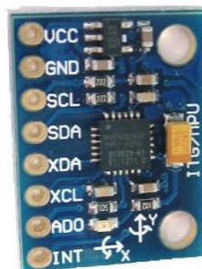
รูปที่ ก.6 แสดงอุปกรณ์วัดการเปลี่ยนแปลงความเร่งเชิงมุมและการเปลี่ยนแปลงความเร่งเชิงเส้น
