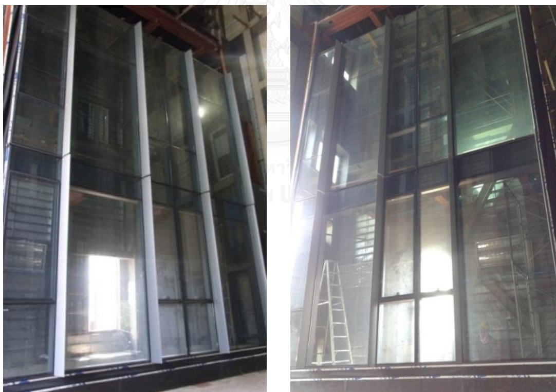
รูปที่ 4.8 รูปตัวอย่างทดสอบที่ 2 ติดตั้งเข้ากับห้องทดสอบ (ความกว้าง 6.27 ม. x ความสูง 8.60 ม.)
