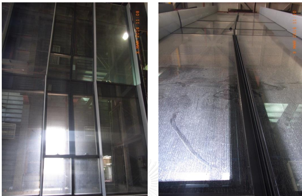
รูปที่ 4.28 ลักษณะการเคลื่อนที่ตามแนวนอนของตัวอย่างทดสอบที่ 2
