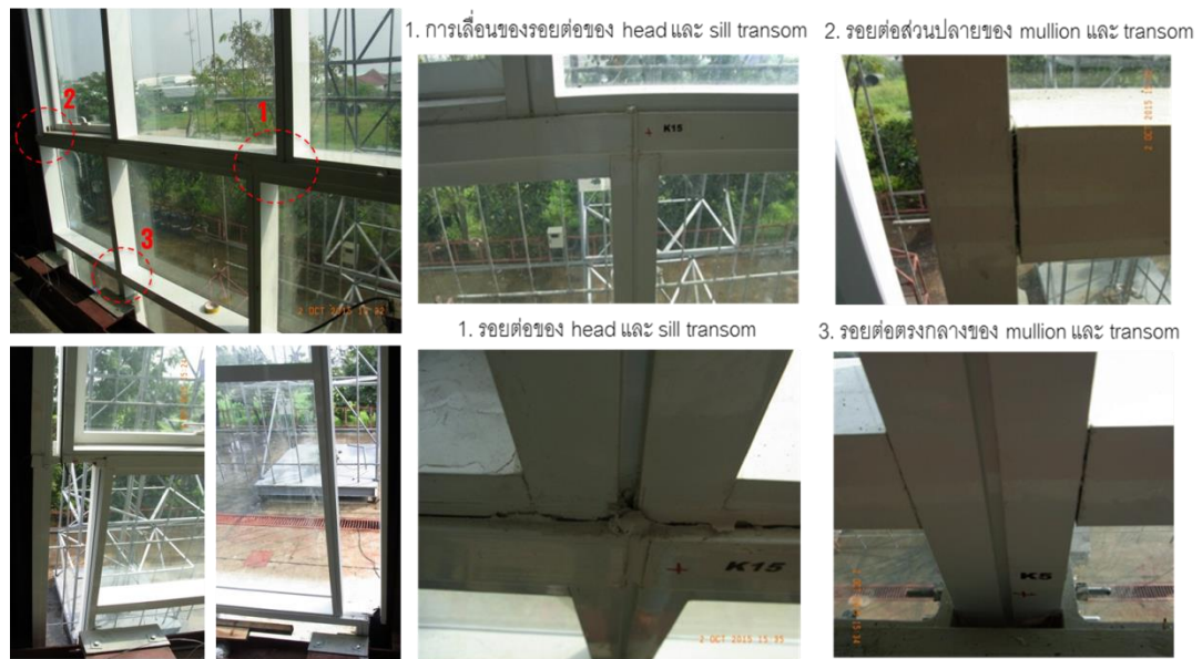
รูปที่ 4.21 ความเสียหายของตัวอย่างทดสอบที่ 1 ภายใต้ระยะการเคลื่อนที่สัมพัทธ์ 3.0% story height
