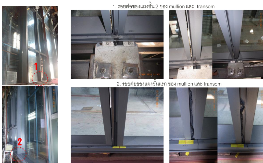
รูปที่ 4.26 ความเสียหายของตัวอย่างทดสอบที่ 2 ภายใต้ระยะการเคลื่อนที่สัมพัทธ์ 4% story height
