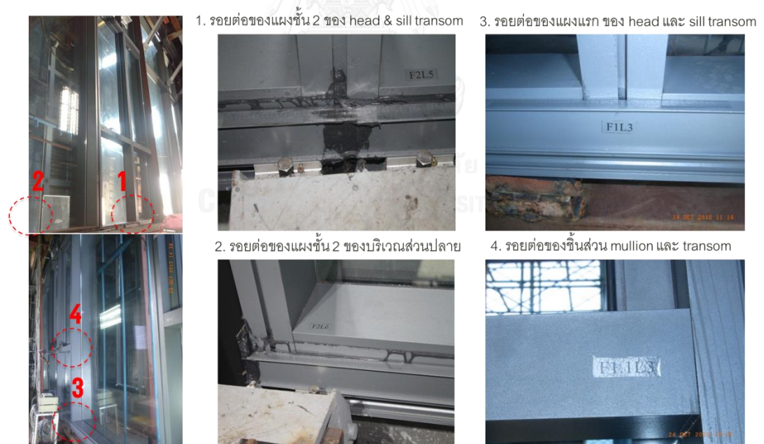
รูปที่ 4.25 ความเสียหายของตัวอย่างทดสอบที่ 2 ภายใต้ระยะการเคลื่อนที่สัมพัทธ์ 1.5% story height
