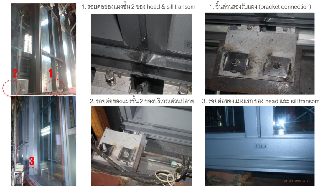
รูปที่ 4.24 ความเสียหายของตัวอย่างทดสอบที่ 2 ภายใต้ระยะการเคลื่อนที่สัมพัทธ์ 1.0% story height
