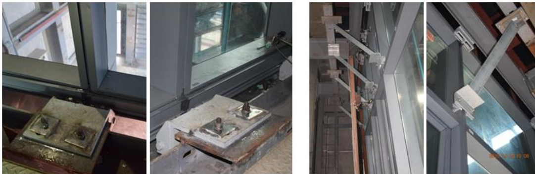
รูปที่ 4.10 ลักษณะจุดรองรับแผงตัวอย่างทดสอบที่ 2
