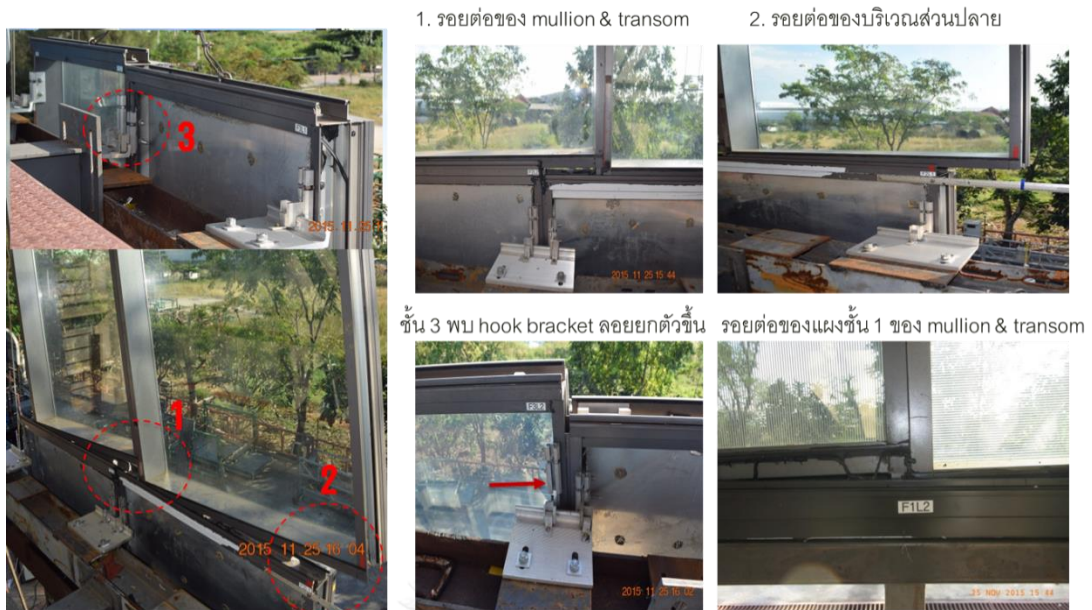
รูปที่ 4.32 ความเสียหายของตัวอย่างทดสอบที่ 3 ภายใต้ระยะ การเคลื่อนที่สัมพัทธ์ 3.5% story height
