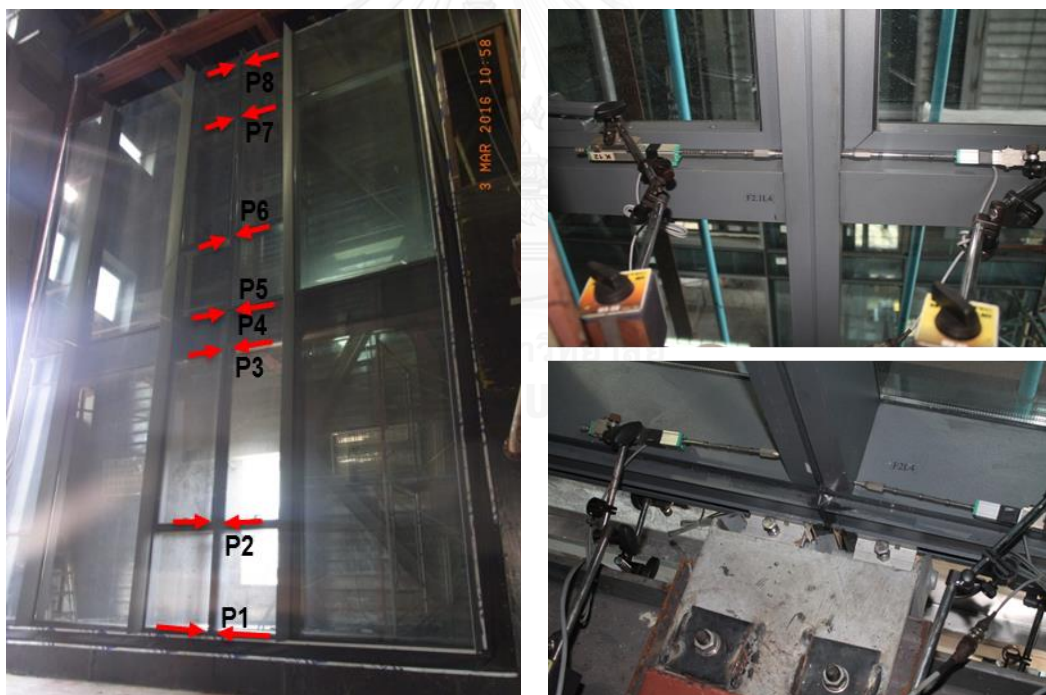
รูปที่ 4.13 การติดตั้งอุปกรณ์วัดการเคลื่อนที่ (LVDT) ของตัวอย่างที่ 2
