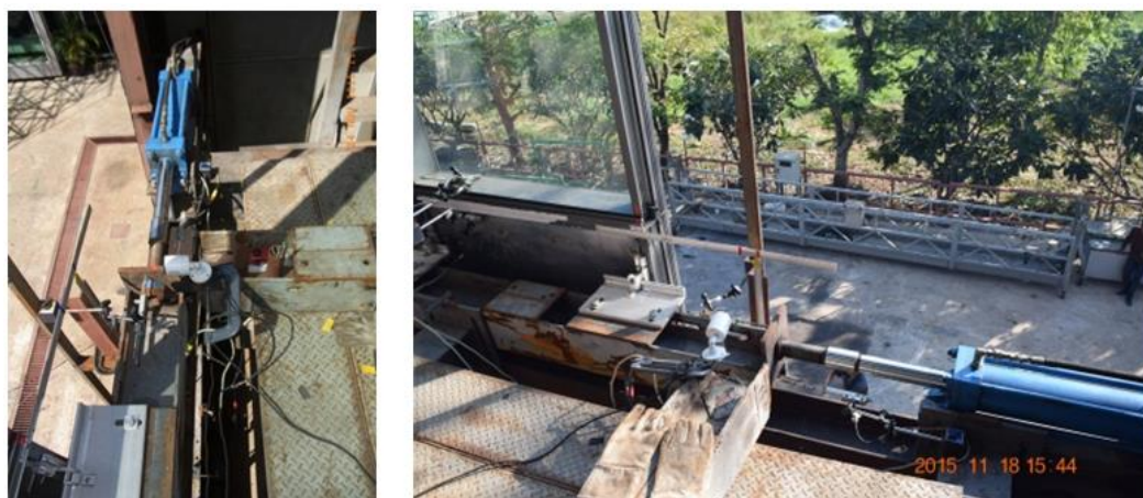
รูปที่ 4.17 การติดตั้งกระบอกไฮดรอลิกเข้ากับคานเพื่อใช้ควบคุมการเคลื่อนที่ของตัวอย่างที่ 3
