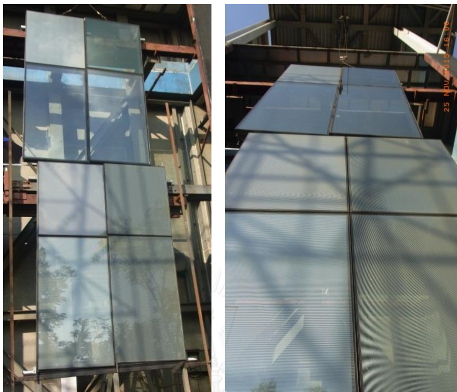
รูปที่ 4.34 ลักษณะการเคลื่อนที่ตามแนวนอนของตัวอย่างทดสอบที่ 3
