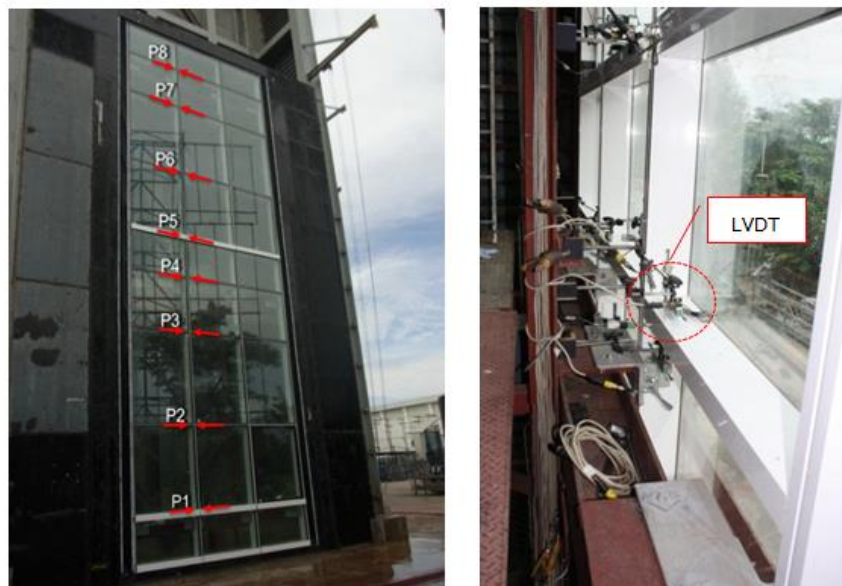
รูปที่ 4.7 ตำแหน่งการติดตั้งอุปกรณ์วัดการเคลื่อนที่ (LVDT) ของตัวอย่างที่ 1
