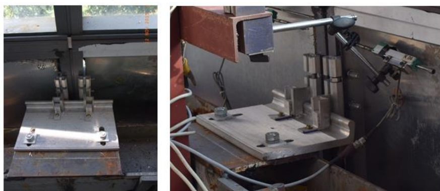
รูปที่ 4.15 ลักษณะจุดรองรับแผงตัวอย่างทดสอบที่ 3
