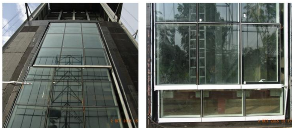
รูปที่ 4.22 ลักษณะการเคลื่อนที่ตามแนวนอนของตัวอย่างทดสอบที่ 1
