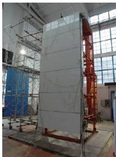
รูปที่ 2.10 การทดสอบ “shake table test” ของผนังเปลือกนอกของอาคาร (Wensheng และ Baofeng, 2008)
