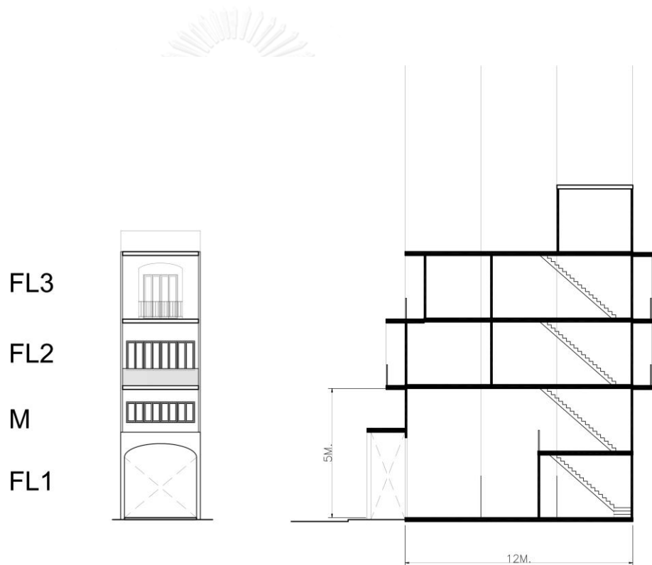
ภาพที่ 4.28 ลักษณะกายภาพตึกแถว 3 ชั้นย่านเมืองใหม่
