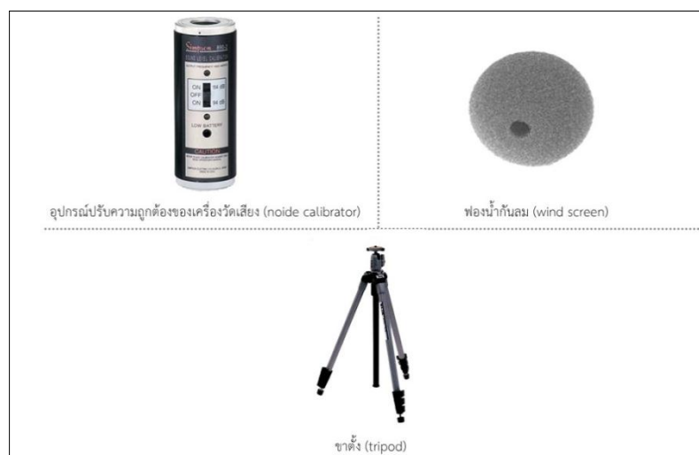
รูปที่ 4 อุปกรณ์ประกอบการตรวจวัดเสียง
