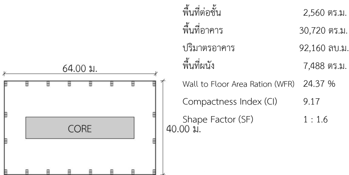
ภาพที่ 3.8: รูปร่างและขนาดของอาคารผังพื้นที่เหลี่ยมผืนผ้า
