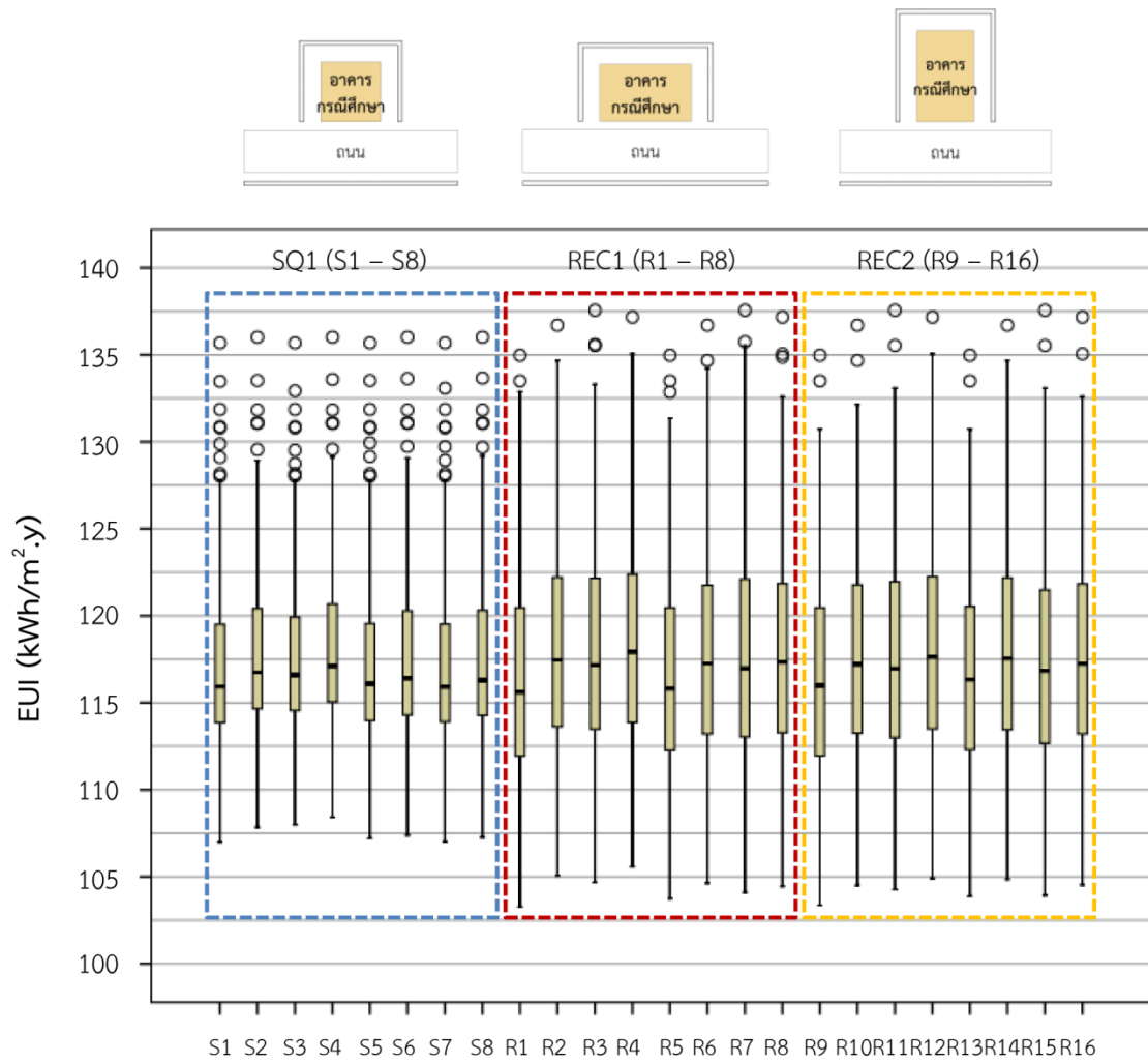
แผนภูมิที่ 4.15: แสดงค่า EUI ของอาคารที่มีรูปทรงและการวางอาคารแบบต่างๆ
