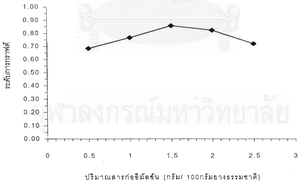
รูปที่ 4.17 ผลของปริมาณสารก่ออิมัลชันต่อระดับการกราฟต์ ที่อุณหภูมิ 60 °ซ ช่วงเวลาเติมมอนอเมอร์ 2 ชั่วโมง
