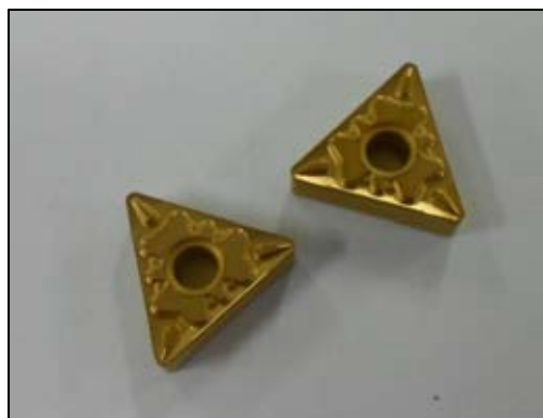
รูปที่ 3.3 เม็ดมีดที่ใช้ในการทดลอง มุมคายเศษโลหะ -6 องศา
