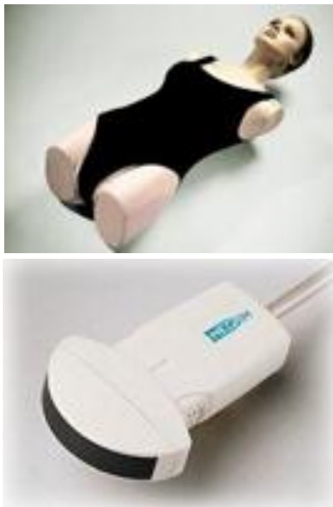
ภาพที่ 2.3 ภาพอุปกรณ์หัวตรวจและหุ่นจำลองที่ขาย UltraSim ของบริษัท MedSim มี อุปกรณ์หัวตรวจจำลองและหุ่นจำลองที่ติดตั้งอุปกรณ์ส่งและรับสัญญาณแม่เหล็กไฟฟ้า ไว้
