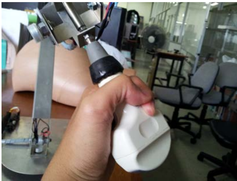
ภาพที่ ก.5 ส่วนหัวตรวจที่ติดอยู่บนแขนกล
