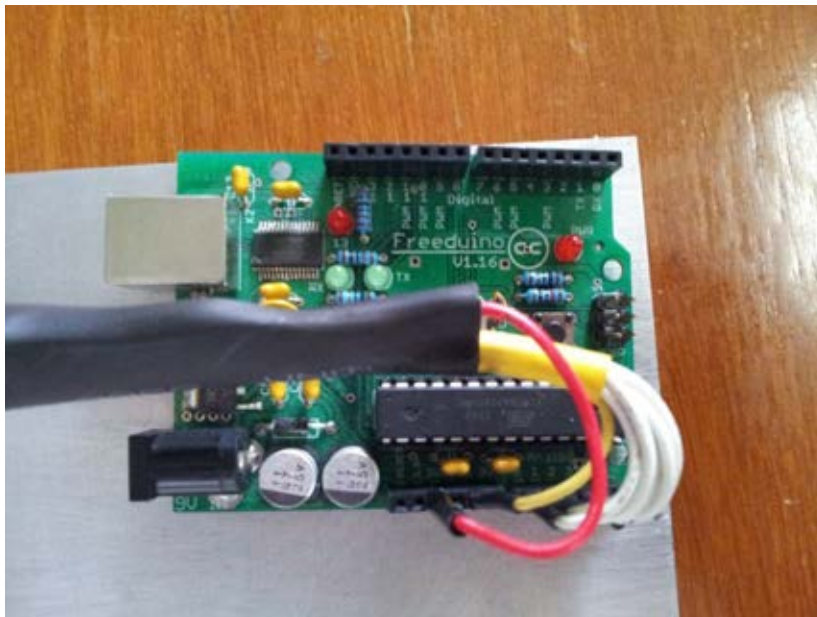
ภาพที่ ก.3 บอร์ดฟรีดูอิโน (Freeduino) ซึ่งเป็นบอร์ดอาร์ดูอิโน (Arduino) รุ่นหนึ่ง ซึ่งรับค่าความต่างศักย์มากจากตัวต้านทานปรับค่าได้
