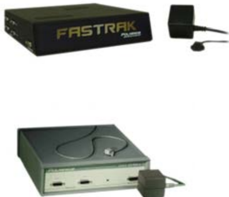
ภาพที่ 2.5 อุปกรณ์ติดตามการเคลื่อนไหวแบบคลื่นแม่เหล็กไฟฟ้า Polhemus FASTRAK (ซ้าย) และ Polhemus Isotrak II (ขวา)
