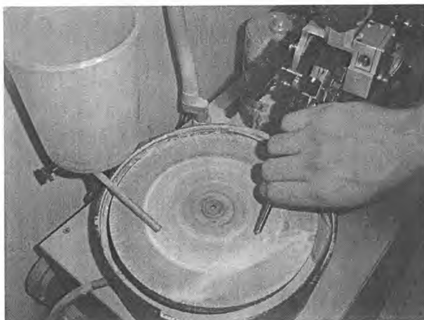
รูปที่ 3.4 การทำ Pre-shaping
