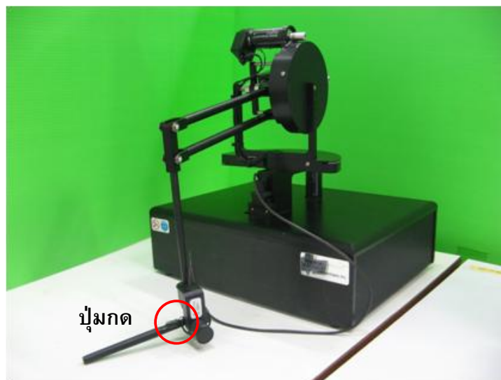
รูปที่ 3.1 ลักษณะของแขนกล PHANTOM® Premium 1.5
