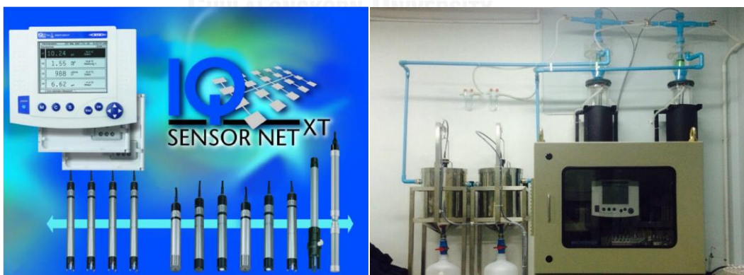
ภาพที่ 3.7 ลักษณะและการติดตั้งเครื่องวัดปริมาณของแข็งแขวนลอยทั้งหมด (TSS)
