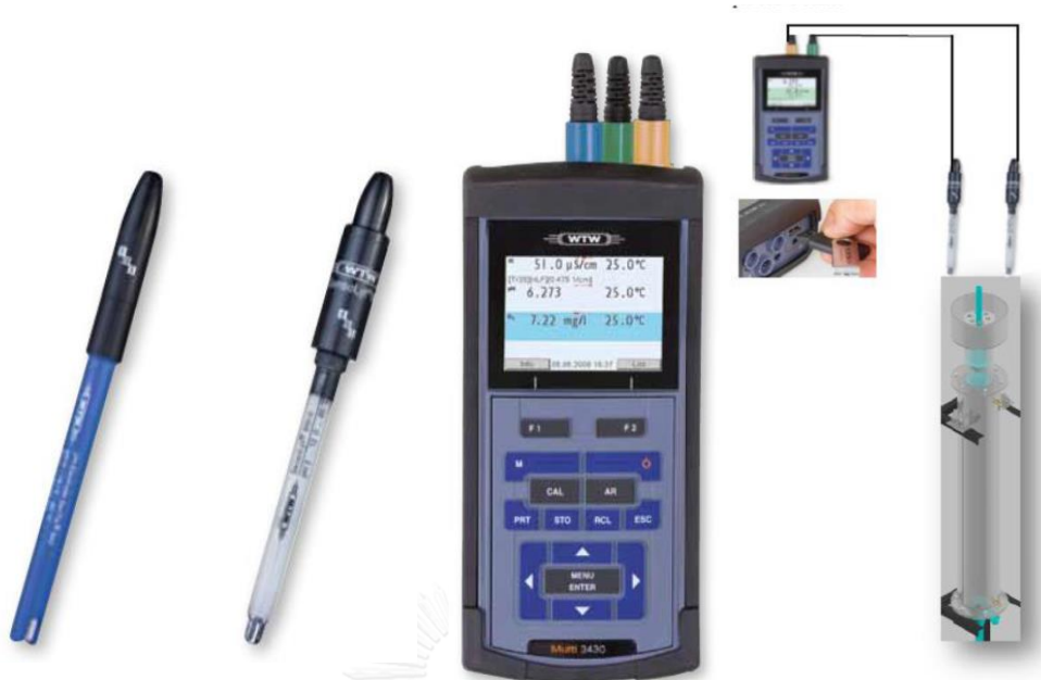
ภาพที่ 3.6 เครื่องวัดค่าพีเอช โออาร์พี และอุณหภูมิ
