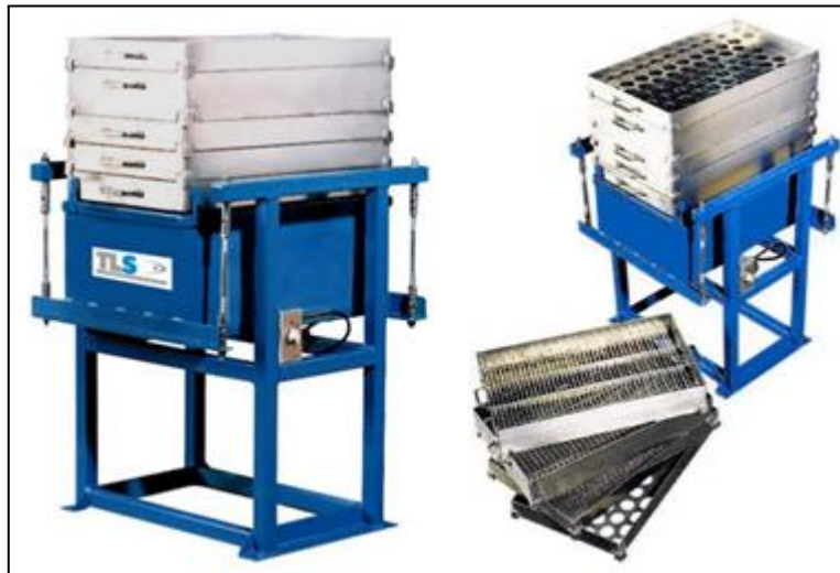
รูปที่ 3.1 เครื่องมือวัด Chip classifier สำหรับแยกประเภทของชิ้นไม้สับ
