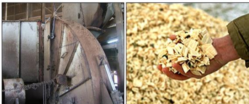
รูปที่ 1.6 การสับไม้จากเครื่องสับ Chipper และชิ้นไม้สับหลังการสับ
