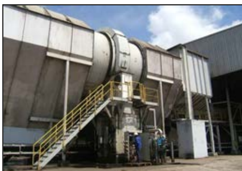
รูปที่ 1.3 การแยกเปลือกออกจากเนื้อไม้โดยชุดคัดแยกเปลือกไม้ (Debarking drum)
