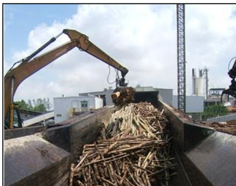
รูปที่ 1.2 การลำเลียงไม้ท่อนที่ผ่านการตรวจสอบแล้ว เข้ากระบวนการผลิต
