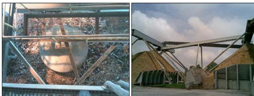
รูปที่ 1.7 การคัดแยกขนาดชิ้นไม้สับ และลานกองเก็บชิ้นไม้สับ
