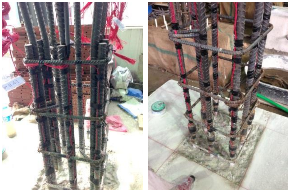
รูปที่ 4.13 การติดตั้งเกจวัดความเครียดของเสา C-SP-100 (ซ้าย) และ C-MS-100 (ขวา)
