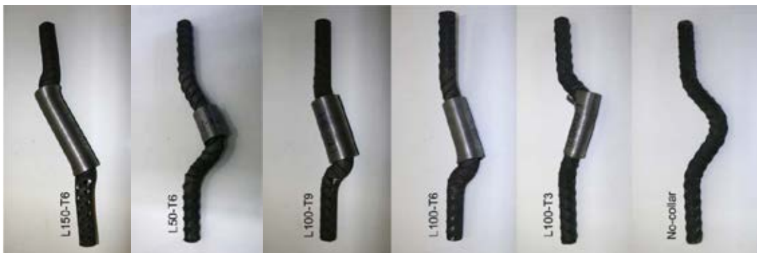
รูปที่ 2.16 ความเสียหายของเหล็กเสริมที่ความเครียด 0.13 (Ruangrassamee และSawaroj ,2010)
