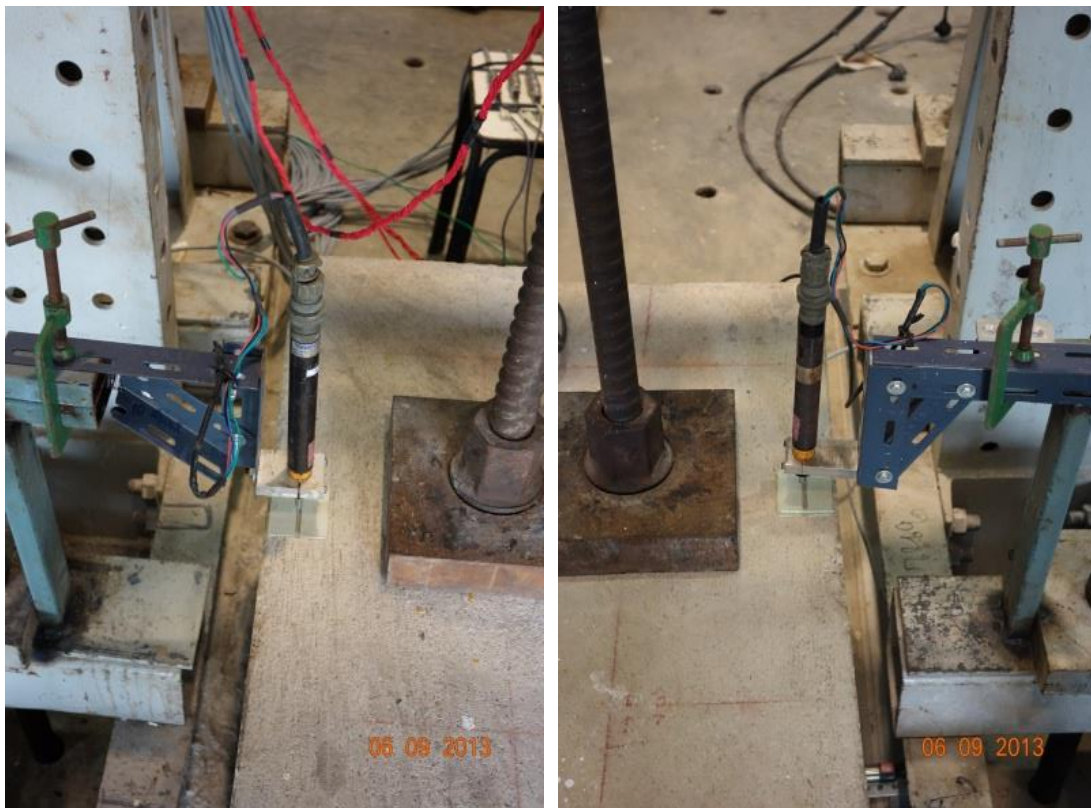
รูปที่ 4.24 การติดตั้งเครื่องวัดการเคลื่อนที่แบบไฟฟ้าที่ใช้วัดการหมุนของฐานราก
