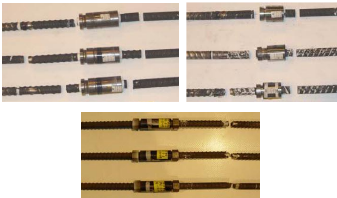
รูปที่ 2.6 การวิบัติที่เหล็กเสริมภายนอกข้อต่อเชิงกลของข้อต่อเชิงกลประเภท Taper-threaded (ซ้าย), Upset-head (ขวา), Threaded-rebar (กลาง) ตามลำดับ (Rowell และ Grey ,2009)
