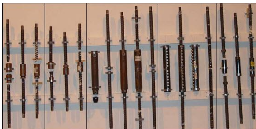
รูปที่ 2.5 ประเภทของข้อต่อเชิงกล Taper-threaded, Upset-head, Grouted-sleeve, Shear-screw, Threaded-rebar ตามลำดับ (Rowell และ Grey ,2009)
