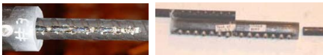
รูปที่ 2.8 การวิบัติในลักษณะที่เหล็กเสริมหลุดออกจอตั้วข้อต่อเชิงกลประเภท Shear Screw (Rowell และ Grey ,2009)
