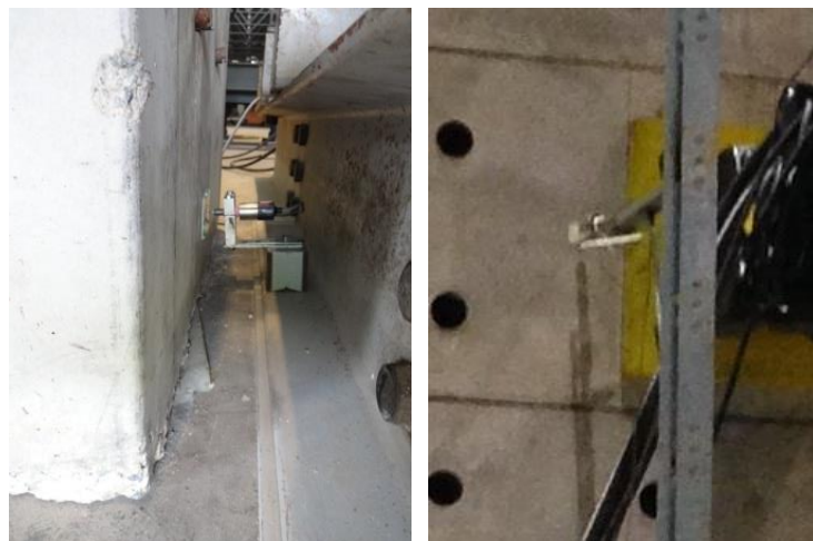
รูปที่ 4.21 ออกแบบอุปกรณ์ติดตั้งเครื่องมีวัดระยะการเคลื่อนที่แบบไฟฟ้า
