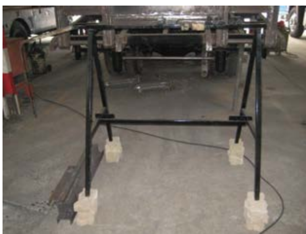
รูปที่ 3.3 ชุดจับยึดชิ้นงาน ที่สามารถปรับระดับความสูงของตำแหน่งชิ้นงานได้
