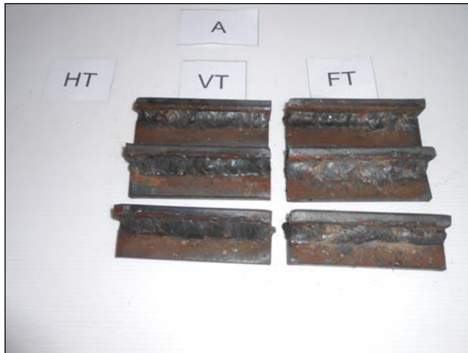
รูปที่ ๓.3 ชิ้นงานที่ไม่ผ่านเกณฑ์คุณภาพของผู้ทดสอบ A รูปแบบงาน VT และ FT
