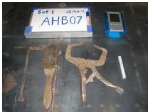
รูปที่ 3.12 ชุดติดตั้งและทำความสะอาดชิ้นงาน
