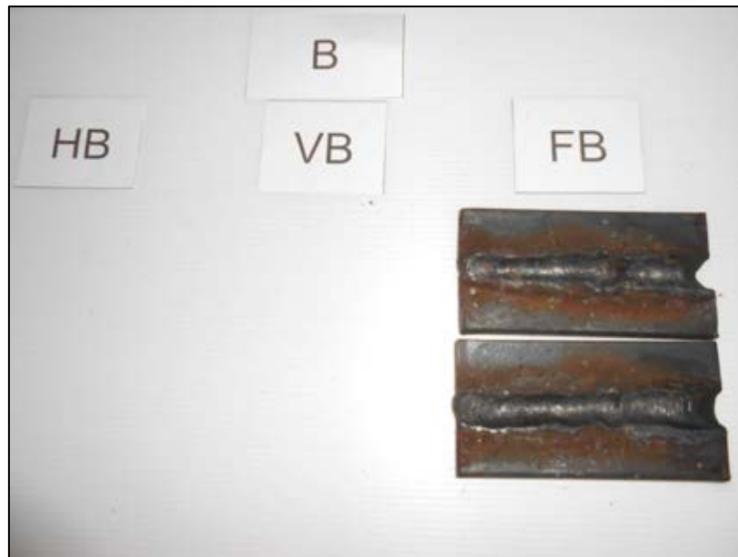
รูปที่ ข.5 ชิ้นงานที่ไม่ผ่านเกณฑ์คุณภาพของผู้ทดสอบ B รูปแบบงาน FB
