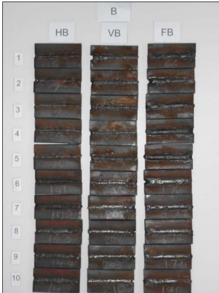
รูปที่ ๑.๔ ชิ้นงานของผู้ทดสอบ B รูปแบบงาน HB, VB และ FB
