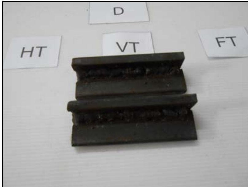
รูปที่ ข.13 ชิ้นงานที่ไม่ผ่านเกณฑ์คุณภาพของผู้ทดสอบ D รูปแบบงาน VT
