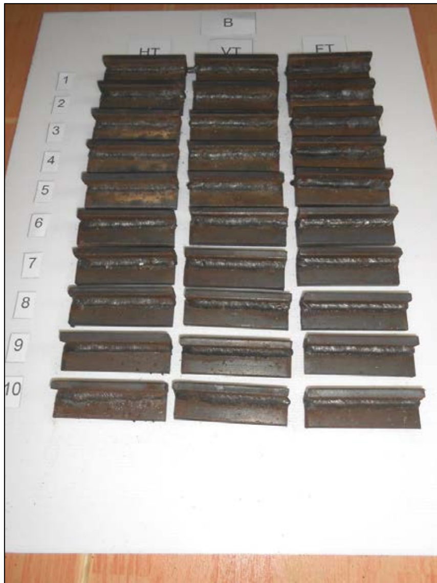
รูปที่ ๑.๖ ชิ้นงานของผู้ทดสอบ B รูปแบบงาน HT, VT และ FT
