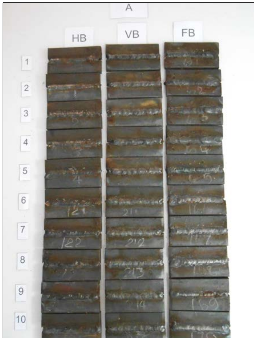
รูปที่ ๑.1 ชิ้นงานของผู้ทดสอบ A รูปแบบงาน HB, VB และ FB
