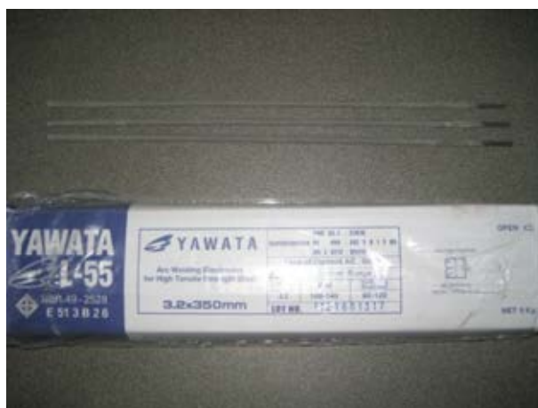
รูปที่ 3.6 ลวดเชื่อมสารพอกหุ้มที่ใช้ในการทดลอง
