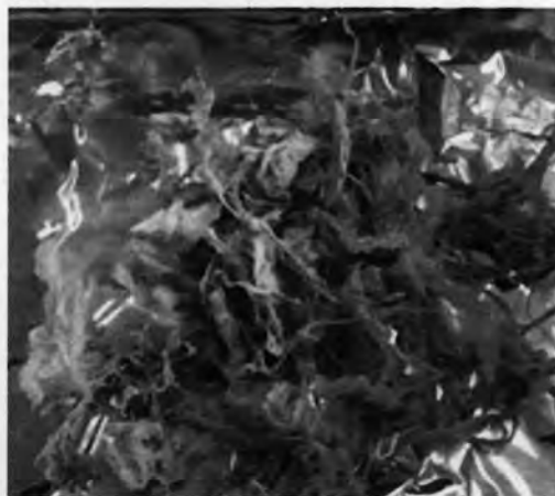
รูปที่ 4.1 ลักษณะทางกายภาพของ a.) เส้นใยนุ่นดิบ และ b.) เส้นใยนุ่นเพิ่มประจุลบเมื่อผ่านการเตรียมเส้นใยแล้วนำไปอบแห้ง
