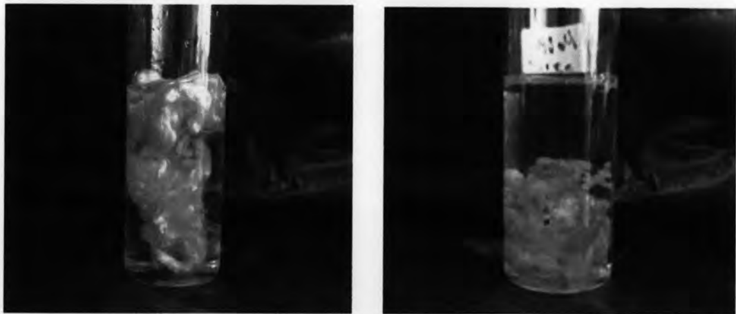
รูปที่ 4.2 ลักษณะทางกายภาพของ a.) เส้นใยนุ่นดิบ และ b.) เส้นใยนุ่นเพิ่มประจุลบเมื่ออยู่ในน้ำ
