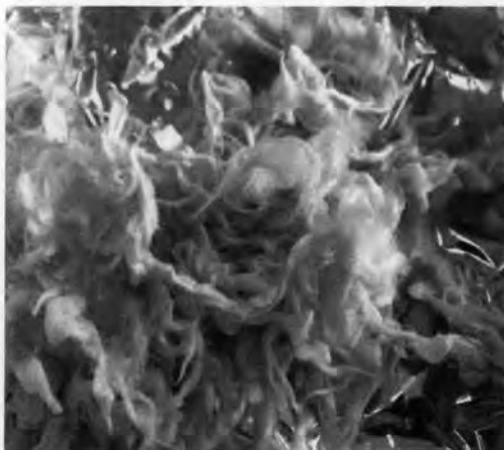
รูปที่ 4.1 ลักษณะทางกายภาพของ a.) เส้นใยนุ่นดิบ และ b.) เส้นใยนุ่นเพิ่มประจุลบเมื่อผ่านการเตรียมเส้นใยแล้วนำไปอบแห้ง
