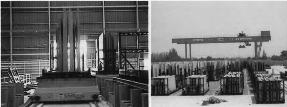
ภาพที่ 4.22 แสดงการจัดเก็บชิ้นส่วนสำเร็จรูปที่ผ่านจากกระบวนการผลิตในระบบโรงงาน
