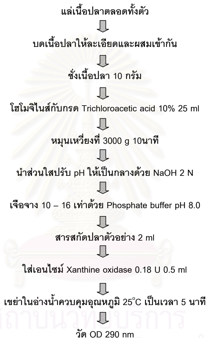
รูปที่ 11 ขั้นตอนการเตรียมสารสกัดปลาตัวอย่างและหาปริมาณ Hypoxanthine ในเนื้อปลาด้วยเอนไซม์ Xanthine oxidase อิสระ
