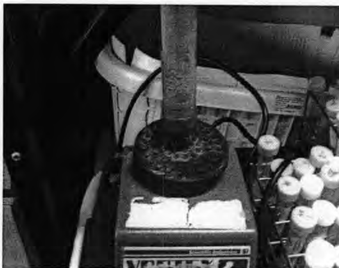
รูปที่ 3-20 การไล่ฟองอากาศด้วยเครื่องหมุนวน
