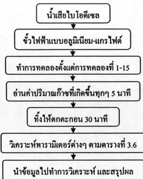
รูปที่ 3.8 ผังการไหลการทดลองหาสภาวะที่เหมาะสมของการออกแบบการทดลองแบบบ็อกซ์-เบห์นเคน โดยใช้โปรแกรมมินิแทป
