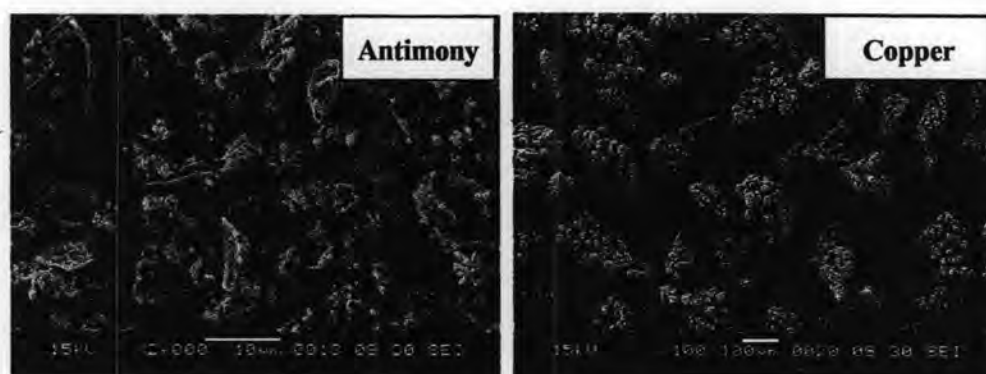
รูปที่ 4.29 ลักษณะขององค์ประกอบที่เป็นโลหะที่เติมลงในผ้าเบรก
