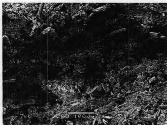
รูปที่ 4.37 โครงสร้างของผ้าเบรกที่ผสมยาง NBR ไมโคร
