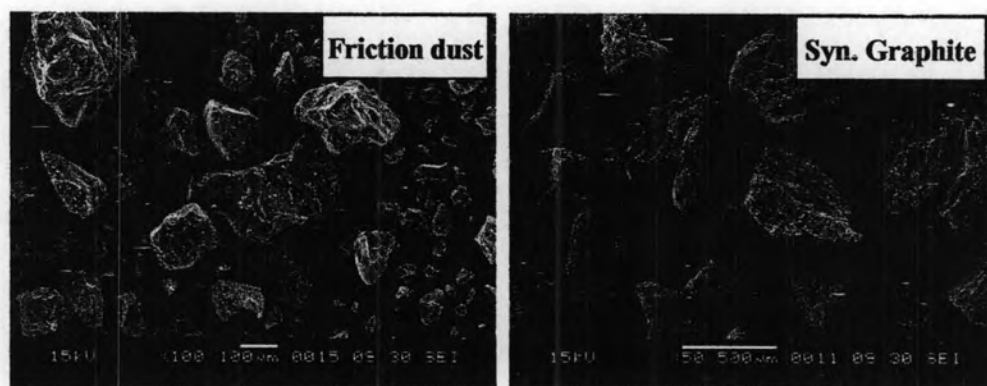
รูปที่ 4.32 ลักษณะขององค์ประกอบที่ทำหน้าที่เป็นสารหล่อลื่นในผ้าเบรก
