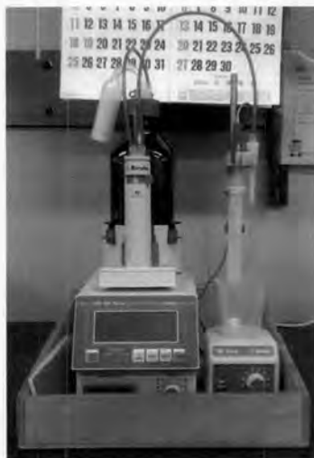
รูปที่ 3.8 เครื่อง autoburette ของ Metrohm 776 Dosimat
