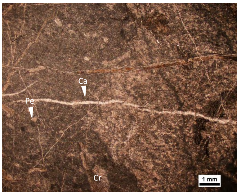
รูปที่ 2.15 หินตัวอย่าง KLD 77 เป็นหิน wackestone ประกอบด้วยเม็ดตะกอนประมาณ 20% และเมทริกซ์ประมาณ 80% โดยตะกอนที่พบส่วนใหญ่เป็น peloid (Pe) และตะกอนชีวภาพพวกโครนอยด์ (Cr) อีกทั้งยังมีสายแร่แคลไซต์ (Ca) ขนาดประมาณ 0.1 มิลลิเมตร
