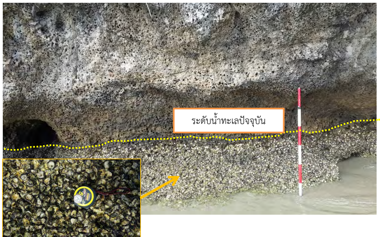
รูปที่ 3.6 รูปแสดงระดับน้ำทะเลปัจจุบันจากชั้นหอยนางรม จุดศึกษาที่ 1
