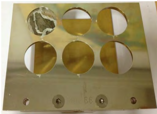
รูปที่ 2.6 แสดงตัวอย่างในการวิเคราะห์องค์ประกอบเคมีทางแร่โดย Electron Probe Micro-Analyzer (EPMA) ด้านซ้าย เป็นตัวอย่างที่เป็นแผ่นหินบางขัดมัน ส่วนรูปด้านขวาเป็นการขึ้นตัวอย่างหินขัดมัน
