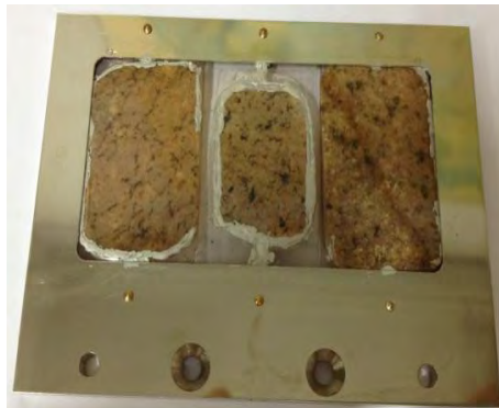
รูปที่ 2.6 แสดงตัวอย่างในการวิเคราะห์องค์ประกอบเคมีทางแร่โดย Electron Probe Micro-Analyzer (EPMA) ด้านซ้าย เป็นตัวอย่างที่เป็นแผ่นหินบางขัดมัน ส่วนรูปด้านขวาเป็นการขึ้นตัวอย่างหินขัดมัน
