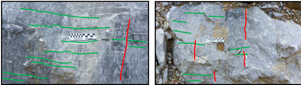
รูปที่3.16 รอยแตก 2 ระบบตัดกัน (สีแดงกับสีเขียว)
