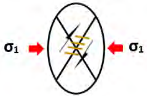
รูปที่3.17 โครงสร้าง gash vein(สีทอง) ที่แสดงถึงความสัมพันธ์กับแรงบีบอัด และทรงรีความเครียด (Strain ellipsoid) ซึ่งอธิบายความสัมพันธ์ระหว่างโครงสร้างกับแรงบีบอัดที่เข้ามากระทำ( \sigma_1 )
