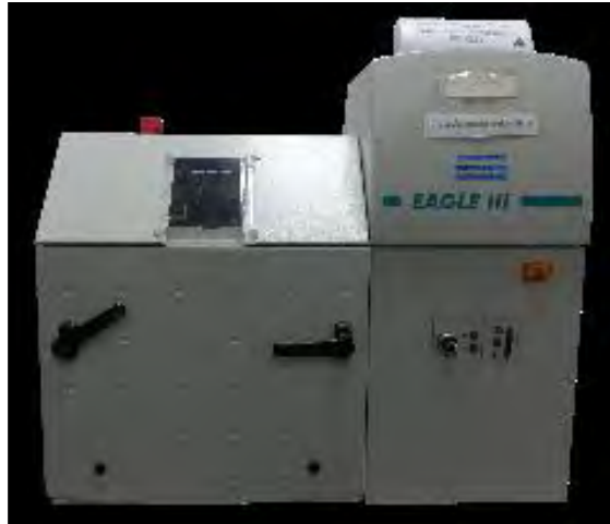
รูปที่ 3.8 เครื่อง EDXRF รุ่น EAGLE III จากสถาบันวิจัยและพัฒนาอัญมณีและเครื่องประดับแห่งชาติ (องค์การมหาชน)
