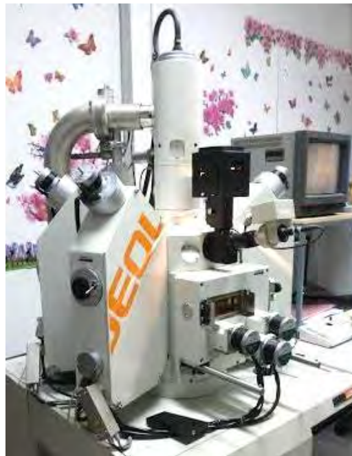
รูปที่ 3.9 เครื่อง EPMA รุ่น JEOL JXA-8100 จากภาควิชาธรณีวิทยา คณะวิทยาศาสตร์ จุฬาลงกรณ์มหาวิทยาลัย
