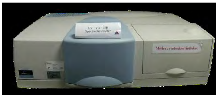
รูปที่ 3.6 เครื่อง UV-VIS-NIR รุ่น Perkin-Elmer จากสถาบันวิจัยและพัฒนาอัญมณีและเครื่องประดับแห่งชาติ (องค์การมหาชน)
