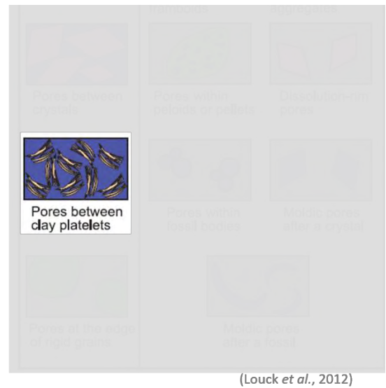
รูปที่ 4.3 รูพรุนชนิดรูพรุนระหว่างแผ่นแร่ดิน (Pore between clay platelets) ลักษณะเด่นของรูพรุนชนิดนี้คือ มีขนาดเล็กและการเชื่อมต่อกันต่ำ (Low connectivity)
