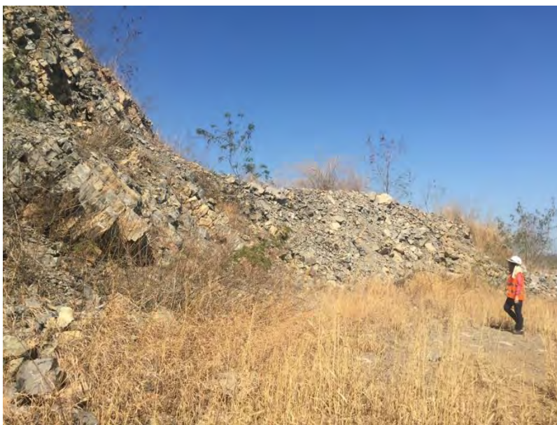
รูปที่ 2.13 หินโผล่ที่พบบริเวณจุดศึกษาที่ 8 พบเป็นชั้นหินมีความหนา 30-50 เซนติเมตรวางตัว 90^{\circ}/45^{\circ} S
