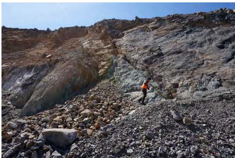
รูปที่ 2.2 รูปแสดงหินโผล่ที่พบบริเวณจุดศึกษาที่1 พบสีฝูสีน้ำตาล และเป็นระนาบรอยเลื่อนในทิศทาง 320^{\circ}/50^{\circ}
