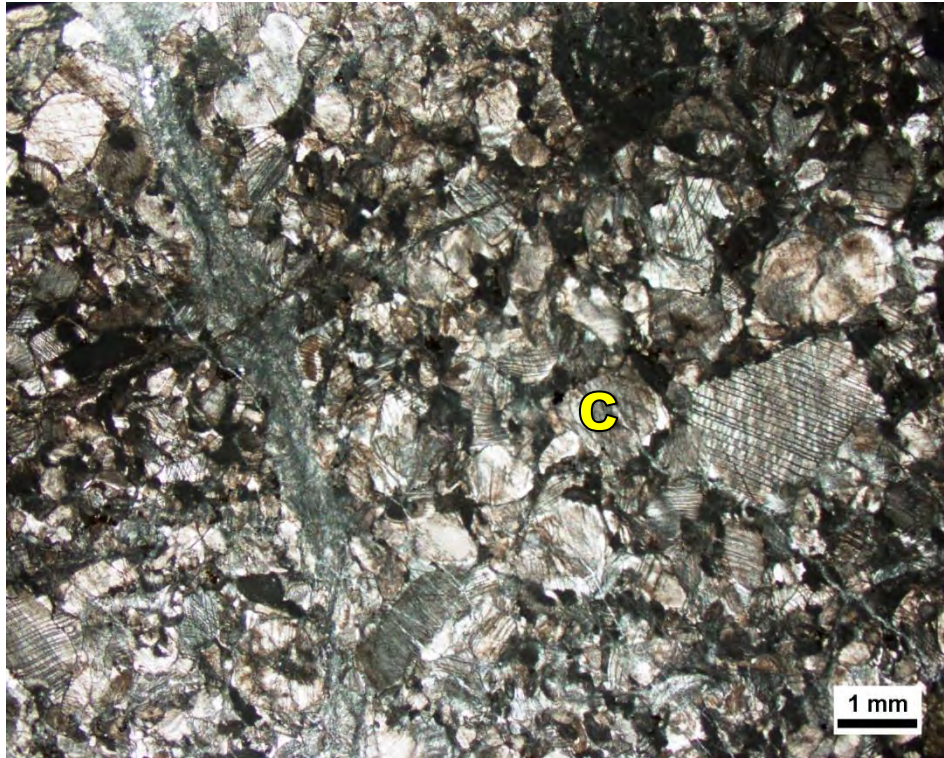
รูปที่ 2.34 ศิลาวรรณนาของตัวอย่างหิน MM24-2 grain ประมาณ 100% ขนาดประมาณ 1-2 มิลลิเมตร พบซากดึกดำบรรพ์ ไครนอยด์ (crinoid) แสดงด้วยสัญลักษณ์ ตัว C ให้ชื่อว่า crinoidal packstone
