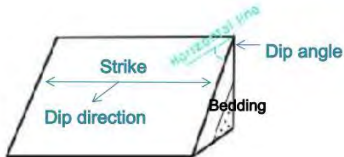
รูปที่ 2.2 การวัดค่าการวางตัวประกอบด้วยแนววางตัว มุมเอียงเท และทิศทางการเอียงเทของชั้นหิน
