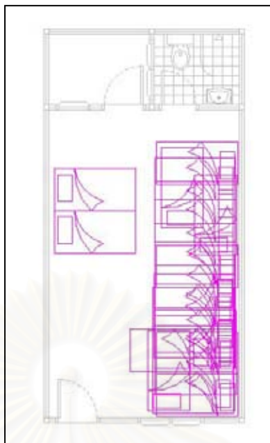
รูปภาพที่ 4.12 แสดงการจัดผังอุปกรณ์เครื่องเรือนแบบชั่วคราว
